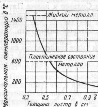
Рис. 9. Выбор толщины металла. Максимальная температура в зависимости от толщины листа
