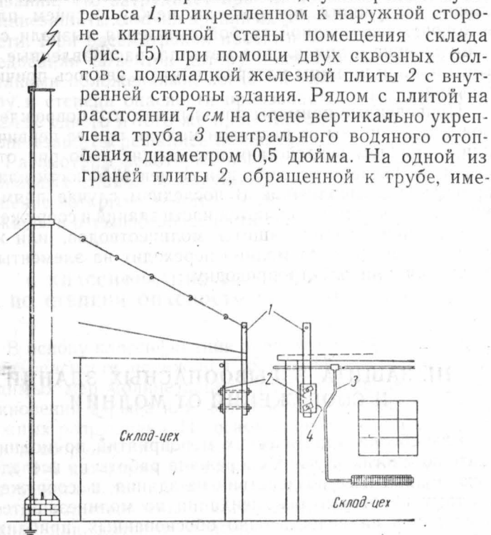
Рис. 15. Схема молниезащиты дымовой трубы и склада — цеха
